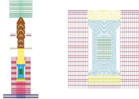
**FIGURE 11. FINITE ELEMENT MESH OF THE S&C TEST**
