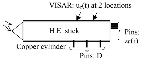
**FIGURE 1 - 3" TEST-CYLINDER CONFIGURATION.**
