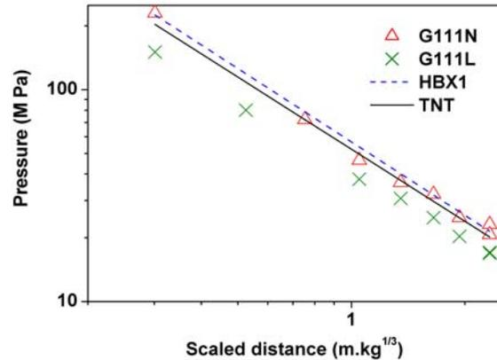
**FIGURE 12 - PEAK PRESSURE VERSUS SCALED DISTANCE**
