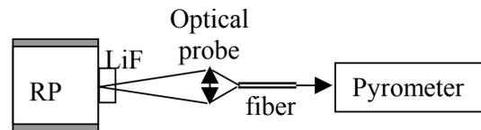
**FIGURE 5 - SYSTEM OF FLUX COLLECTION.**
