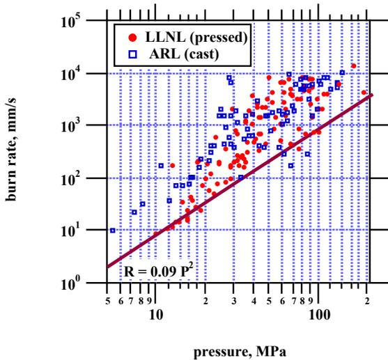
**FIGURE 8. DEFLAGRATION RATE DATA FOR COMPOSITION B CALCULATED FROM EMBEDDED WIRES, SHOWING SLOW INITIAL DEFLAGRATION FOLLOWED BY RAPID (DECONSOLIDATIVE) BURNING**
