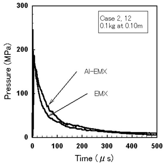
**FIGURE 4. EXAMPLE OF SHOCK WAVE PROFILE**
