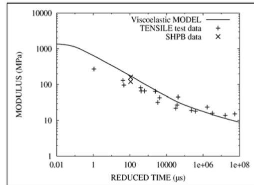
**FIGURE 1. B2211 TENSILE TEST AND SHPB DATA**
