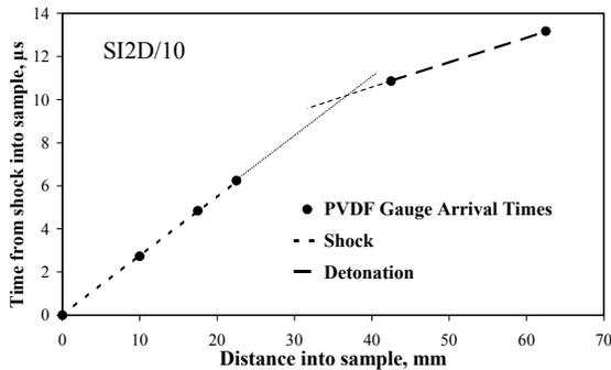
**FIGURE 14. SI2D/10 X-T PLOT FROM GAUGE TIMES**
