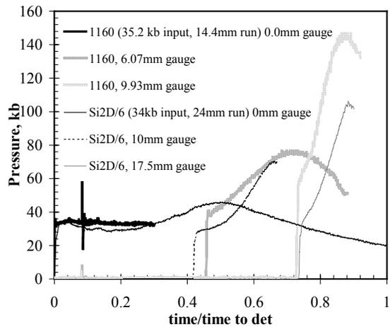
**FIGURE 15. COMPARISON OF GAS GUN AND SI2D DATA.**
